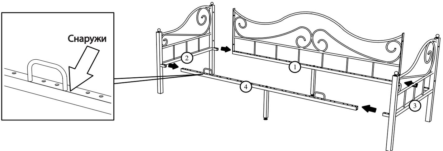
3. **ВАЖНО:** все винтовые соединения сначала необходимо «наживить», обтяжка производится после установки всех деталей. Соединить через отверстия в боковых пластинах спинку заднюю (1) со спинками боковыми (2), (3) винтом M8x40 (6) с шайбой (7) и гайкой глухой M8 (10). Соединить царгу (4) и спинку заднюю (1) через выступы спинок боковых (2), (3) винтом M8x40 (6) с шайбой (7) и гайкой M8 (8).
