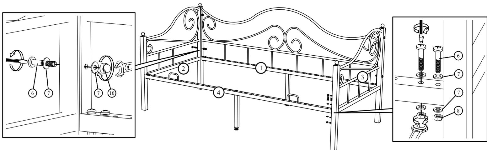
4. Для получения прямоугольности выровнять кровать по диагональ X и Y и зажать гаечным ключом Все винтовые соединения по периметру. **ВАЖНО: затягивать гайки до момента фиксации кровати в устойчивом положении (возможно замятие металла).** Отрегулировать резьбовой упор в дополнительных ножках (5).
