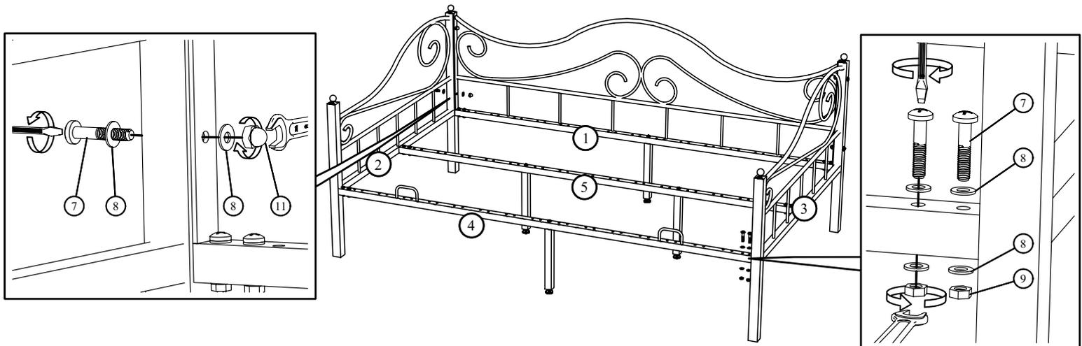
4. Для получения прямоугольности выровнять кровать по диагонал X и Y и зажать гаечным ключом Все винтовые соединения по периметру. **ВАЖНО: затягивать гайки до момента фиксации кровати в устойчивом положении (возможно замятие металла).** Отрегулировать резьбовой упор в дополнительных ножках (6).
