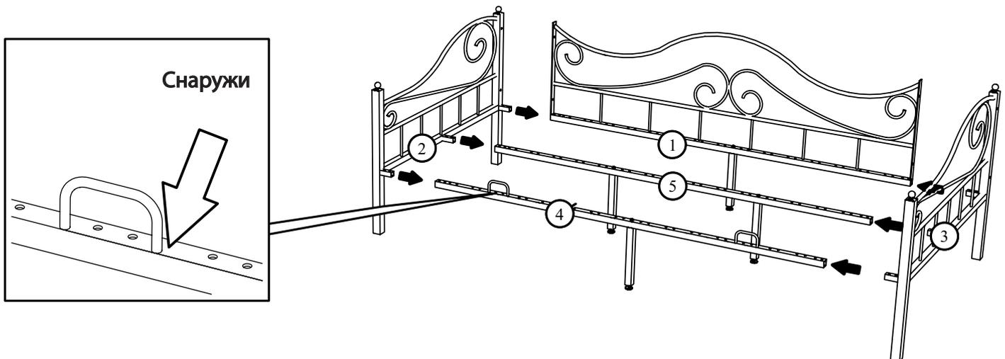
3. **ВАЖНО:** все винтовые соединения сначала необходимо «наживить», обтяжка производится после установки всех деталей. Соединить через отверстия в боковых пластинах спинку заднюю (1) со спинками боковыми (2), (3) винтом M8x40 (7) с шайбой (8) и гайкой глухой M8 (11). Соединить царгу (4), (5) и спинку заднюю (1) через выступы спинок боковых (2), (3) винтом M8x40 (8) с шайбой (8) и гайкой M8 (9).
